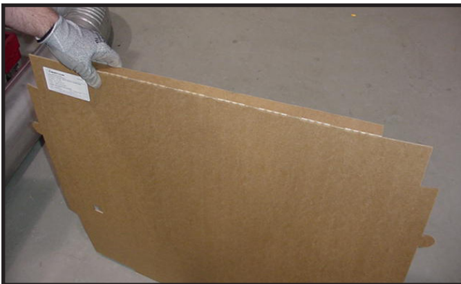
Figure 13.2 Étape 3. Pliez les rabats gauche et droit du protecteur antiéclaboussure en suivant la ligne tracée au couteau en guise de guide. Voir la Figure 13.8.
