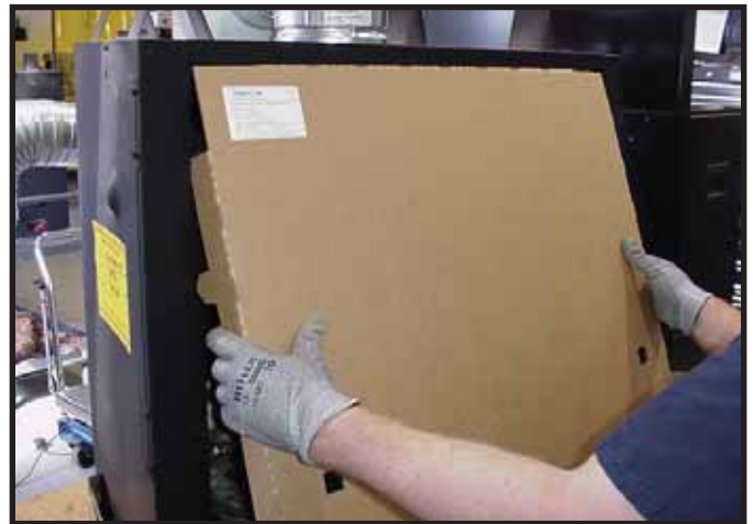
Figura 13.4 Instalación del protector de salpicaduras
