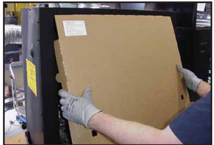
Figure 13.4 Installation de l'écran anti-éclaboussures
