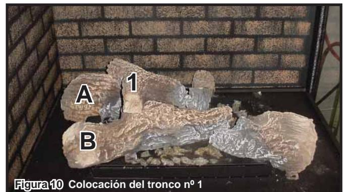
**PASO 1. Leño Nº 1 (SRV2129-704):** Coloque el leño nº 1 sobre el leño A. El extremo inferior del leño nº 1 se debe encajar en la hendidura del leño A la cual se muestra en la Figura 9. El extremo en forma de Y debe descansar en la parte lisa del leño B como se muestra la Figura 10.
