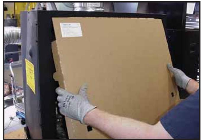
Figura 13.4 Instalación del protector de salpicaduras
