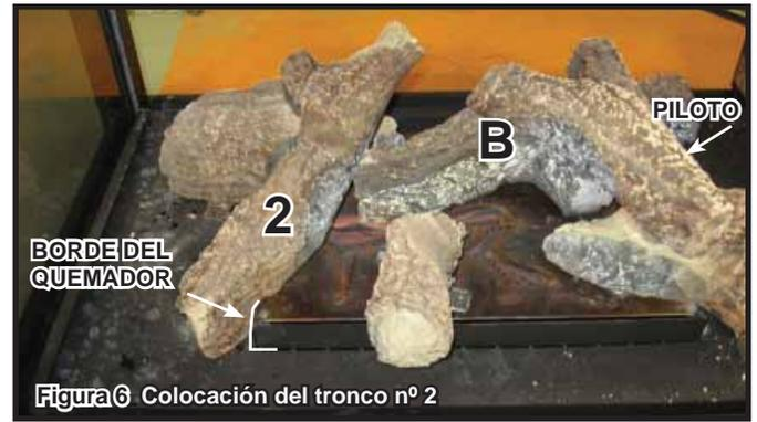
**PASO 2. Leño Nº 2 (SRV2129-705):** Coloque la porción delineada del leño nº 2 que se muestra en la Figura 5 sobre la hendidura el leño C. El leño nº 2 debe descansar sobre la punta del leño B. Deslice la parte inferior del leño nº 2 hacia abajo de manera que toque el borde del quemador como se muestra en la Figura 6.
