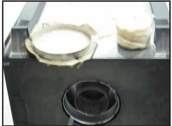
**Figura 9.7** Deseche la tapa selladora, el tapón de aislamiento y el retenedor de aislamiento.
