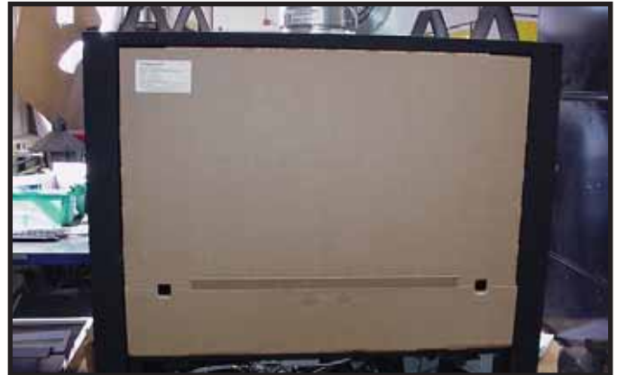
Figura 13.10 Protector de salpicaduras con panel inferior abierto
