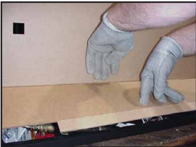
Figura 13.8 Abra el panel de acceso inferior
