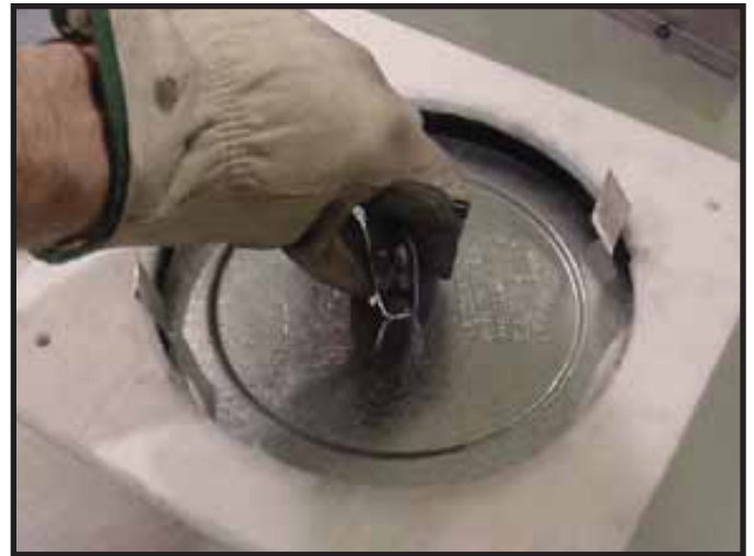
Figura 9.3 Doble el centro de la banda de retención y úsela para retirar la tapa selladora.
