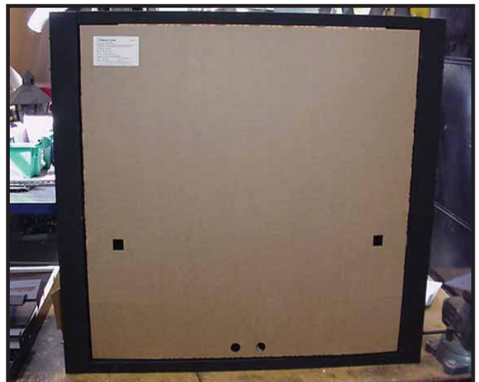
Figura 13.11 Protector de salpicaduras con panel inferior cerrado
