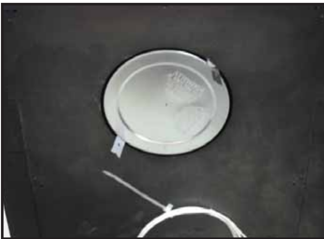
Figura 9.6 Retire la tapa selladora.
