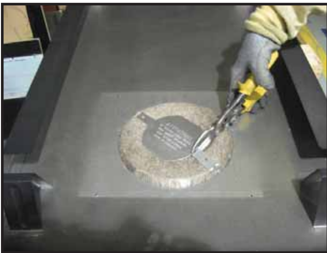
Figura 9.2 Corte la banda de retención y doble los lados hacia afuera.
