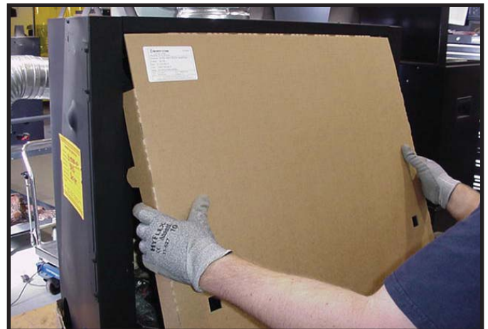
Figure 13.4 Installation de l'écran anti-éclaboussures
