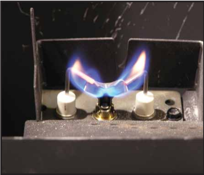
Figura 3.1 Apariencia de las llamas de un piloto IPI
