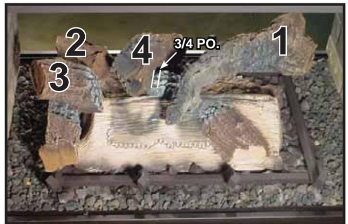
**ÉTAPE 5. BÛCHE N° 4 (SRV2005-703) :** Positionner l'encoche aiguë se trouvant sur la bûche n° 4 contre la dent de la grille, tel qu'illustré. L'échancrure douce située sur la partie inférieure de la bûche n° 4 doit reposer sur la surface du brûleur. Le côté de la bûche n° 4 doit être situé à une distance de 19,05 mm (3/4 po.) du trou de buse le plus près du côté droit de la bûche n° 4. **NE PAS** recouvrir les trous des buses.
