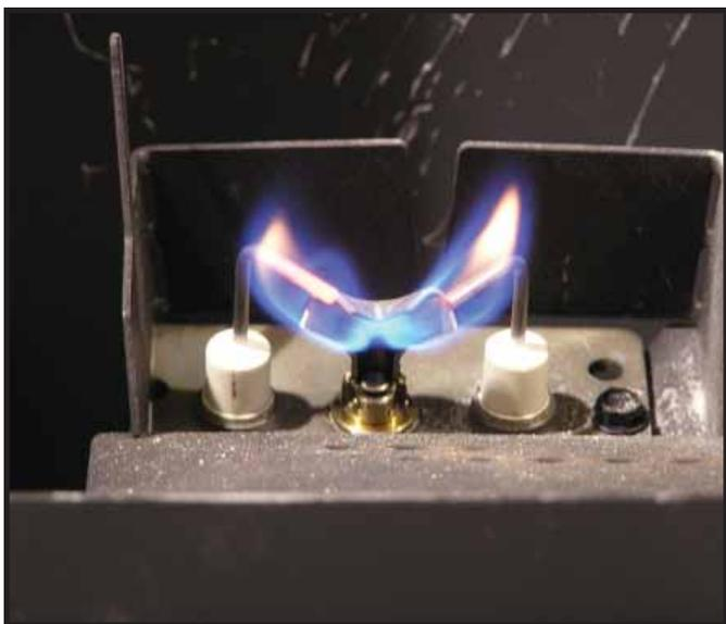
**Figure 3.1** Forme de la flamme d'une veilleuse Intellifire
