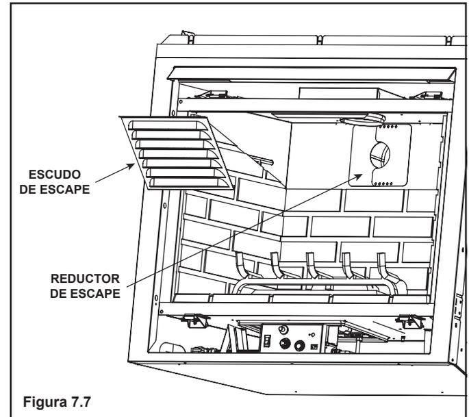
2. Quíbre el reductor de escape en dos partes. Usted puede hacerlo doblando la pieza de atrás para adelante hasta que se quíbre (vea la Figura 7.8).
