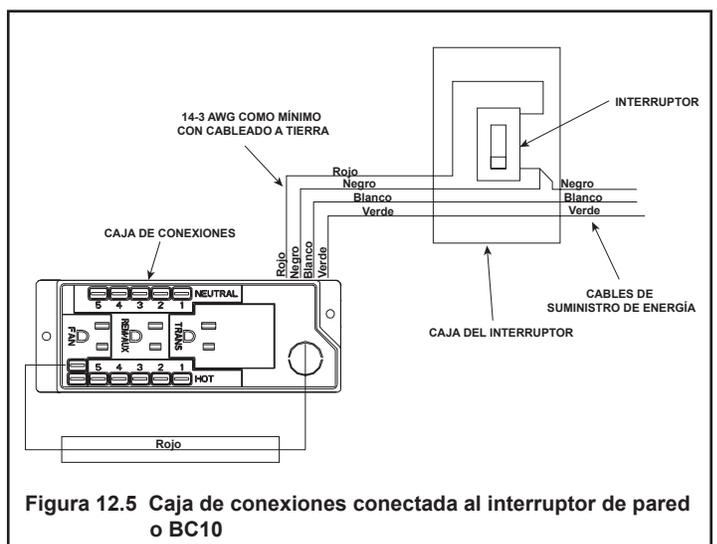
Figura 12.5 Caja de conexiones conectada al interruptor de pared o BC10
