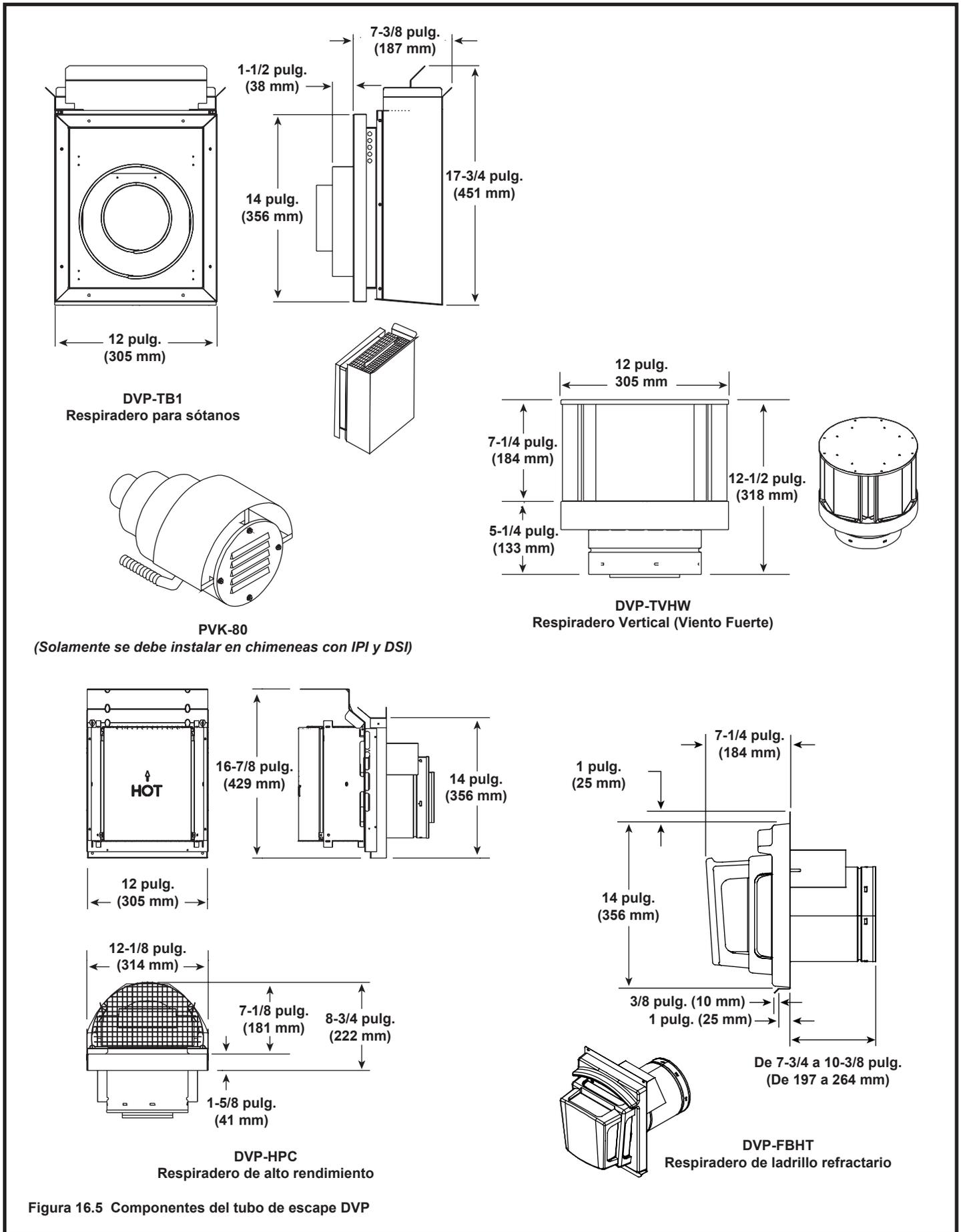
Figura 16.5 Componentes del tubo de escape DVP
