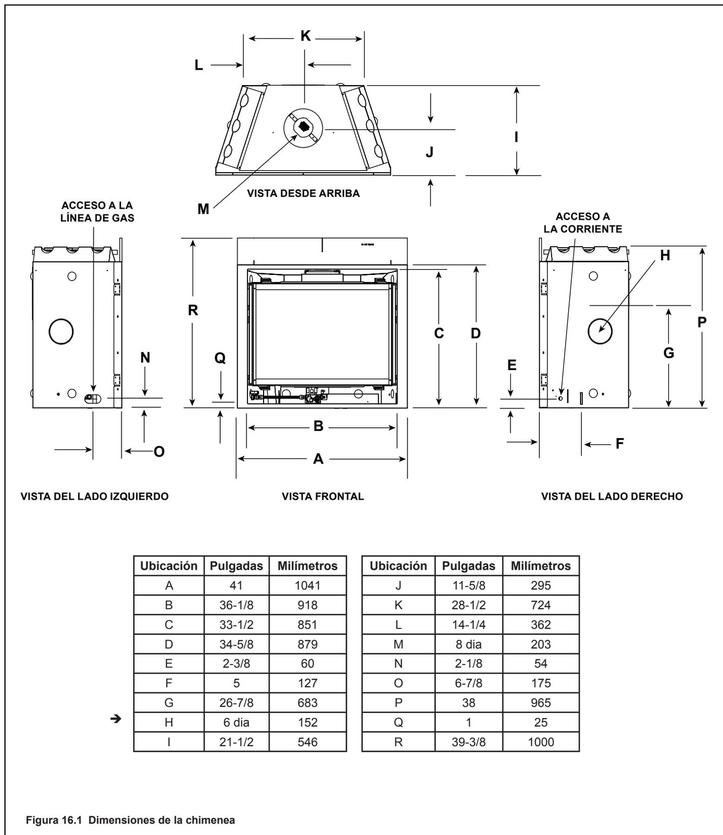
Figura 16.1 Dimensiones de la chimenea
