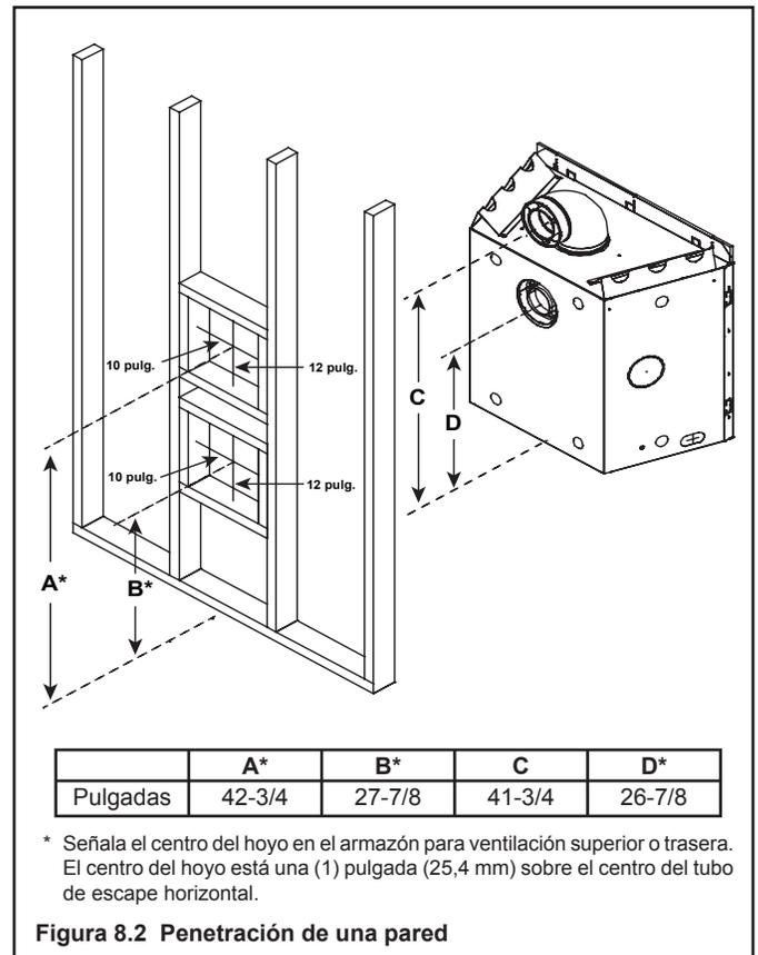
**Nota:** Si la chimenea es ventilada por arriba usando tubo SLP y con una terminación horizontal, se DEBE hacer un hoyo de 10 pulg. x 10 pulg.
