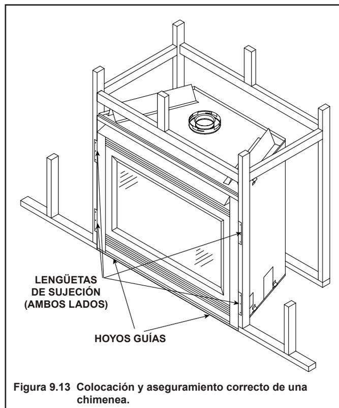
**Figura 9.13** Colocación y aseguramiento correcto de una chimenea.
