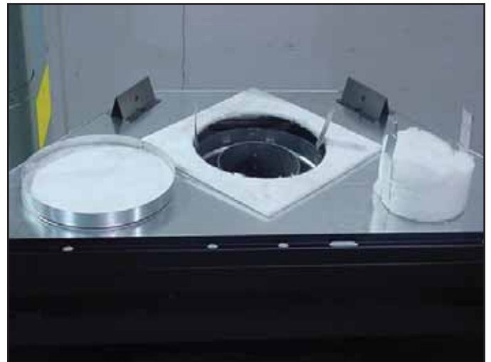
Figura 7.5 Deseche la tapa del tubo de escape. Retire y deseche el tapón de aislamiento. Nota: Una vez que haya retirado la tapa del tubo de aislamiento NO PODRÁ volverla a poner.
