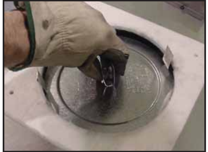
Figura 7.4 Doble la parte del centro de la banda retentora y úsela para retirar la tapa del tubo de escape.
