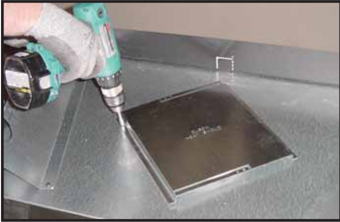
Figure 7.1 Pour l'évacuation par-dessus, enlevez les deux vis qui attachent l'écran de chaleur du coude. Utilisez cet écran de chaleur par dessus le premier coude, si applicable. Pour l'évacuation arrière, sautez cette étape.
