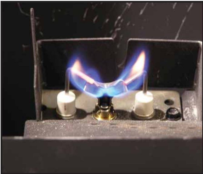
Figure 3.1 Forme de la flamme d'une veilleuse IntelliFire
