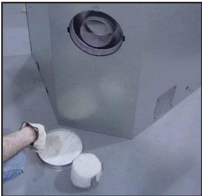
Figura 9.10 Deseche la tapa selladora. Retire y deseche el tapón de aislamiento.
