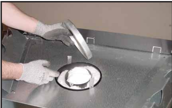
Figura 9.3 Retire la tapa selladora.
