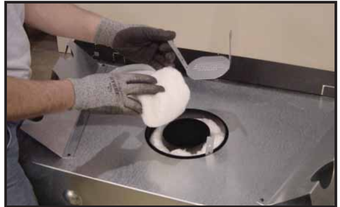
Figura 9.4 Retire el retenedor de aislamiento y saque el aislamiento que está dentro del tubo central.
