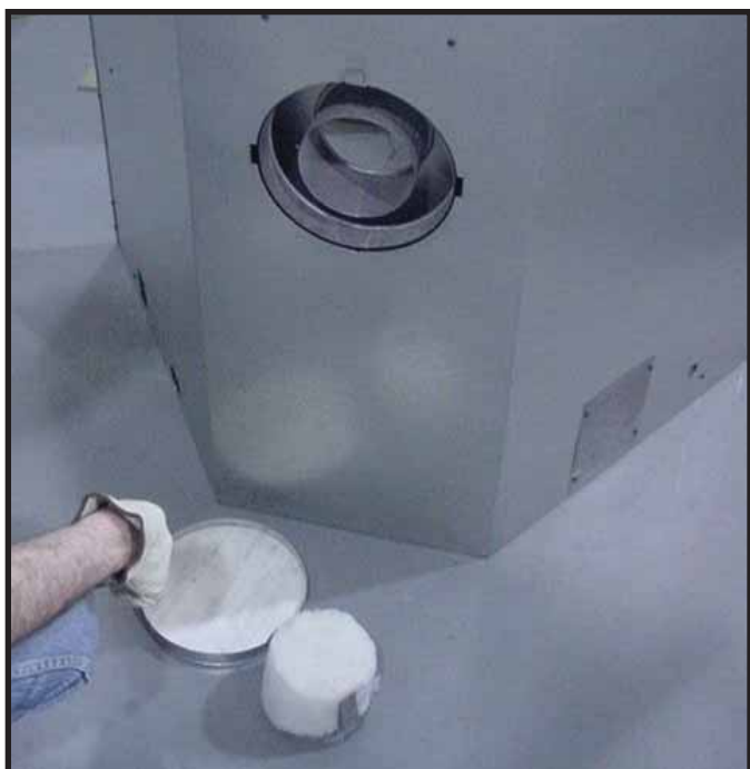
Figure 9.11 Jetez le capuchon plombé, retirez et jetez le panier d'isolant.
