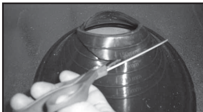
Figure 10.19 Tailler le fourreau protecteur en caoutchouc
