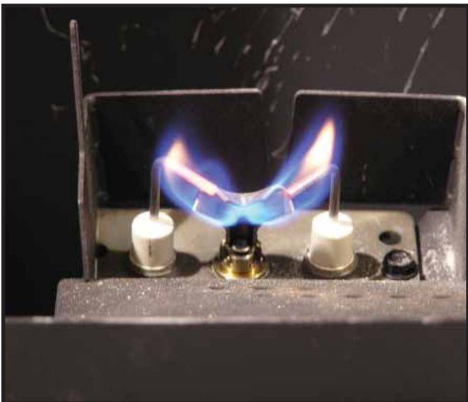
Figure 3.1 Forme de la flamme d'une veilleuse Intellifire
