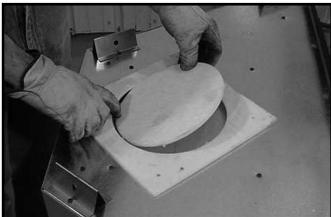
**Figure 7.2** Enlever le bouchon d'isolation central.
