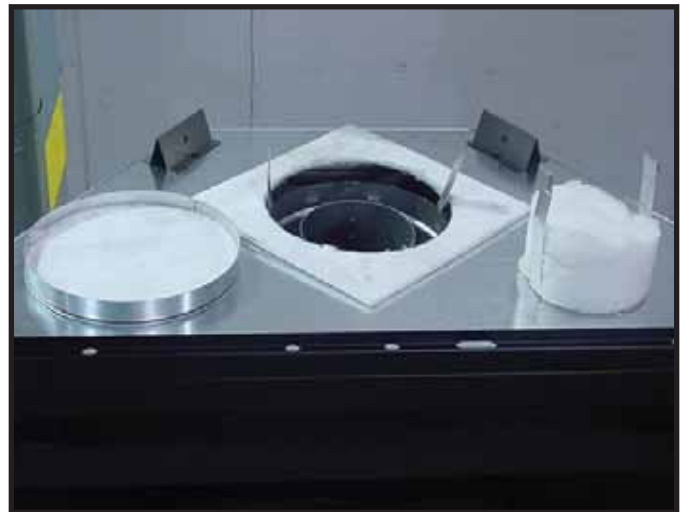
Figura 9.5 Deseche la tapa selladora. Retire y deseche el tapón de aislamiento. Nota: Una vez que haya retirado la tapa selladora NO PODRÁ volver a instalarla.
