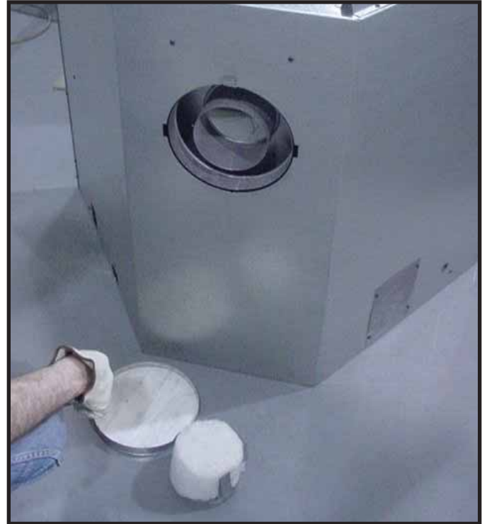
Figura 9.9 Deseche la tapa selladora. Retire y deseche el tapón de aislamiento.
