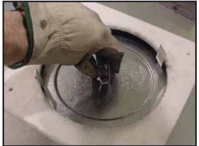
Figura 9.4 Doble el centro de la banda de retención y úsela para retirar la tapa selladora.
