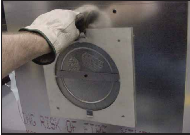
Figura 9.6 Doble las lengüetas hacia el centro de la tapa selladora (90°) y retire la empaquetadura.
