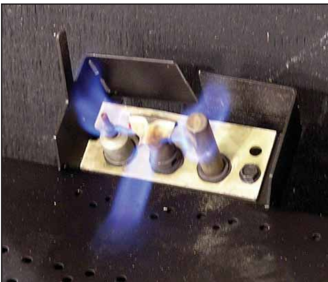
Figura 3.2 Apariencia de las llamas de un piloto fijo
