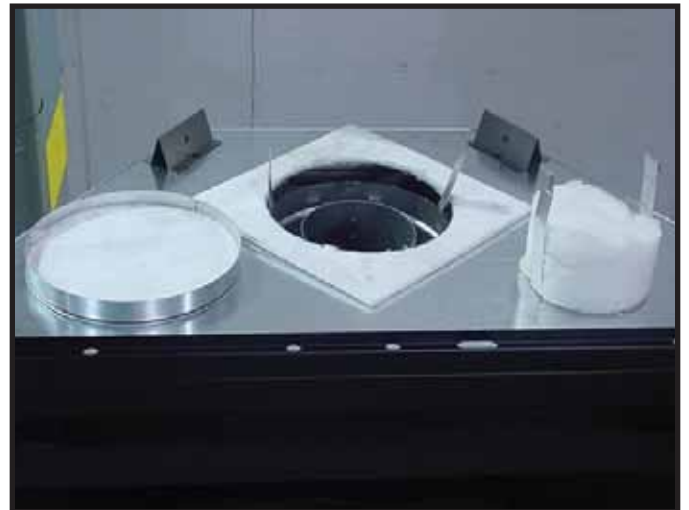
Figure 9.5 Jetez le capuchon plombé, retirez et jetez le panier d'isolant. Note : Après avoir retiré le capuchon plombé, il NE peut PAS être réinstallé.
