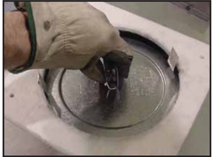
Figure 9.4 Repliez les parties centrales de la bande de retenue vers le haut et utilisez cela pour retirer le capuchon plombé.
