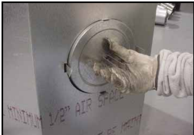
Figure 9.8 Repliez les parties centrales de la bande de retenue vers l'extérieur et utilisez cela pour retirer le capuchon plombé.
