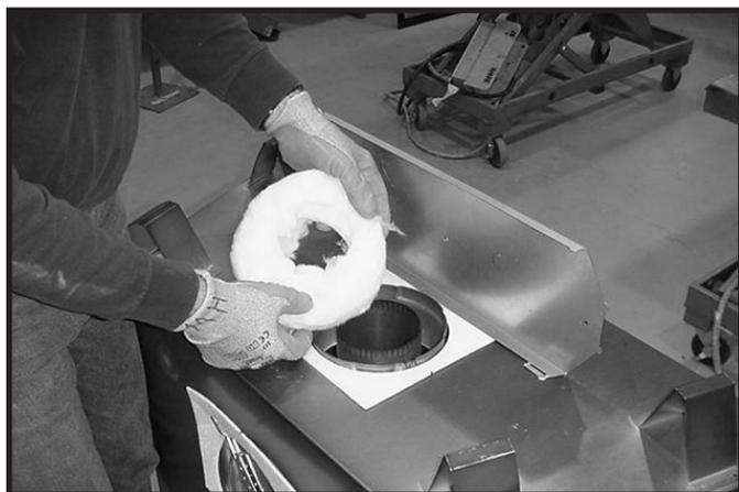
**Figure 6.10** Retirez l'isolation du conduit d'évacuation des gaz extérieur.
