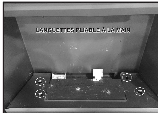
Figure 3. Emplacements des languettes pliable à la main - QUARTZ36 indiqué
