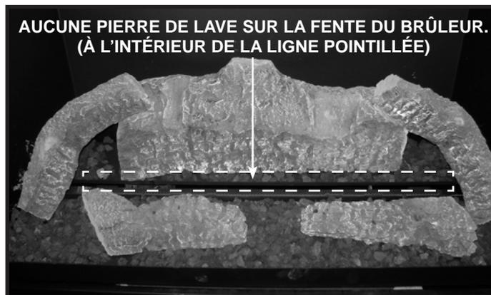
Figure 12. Recouvrement de la fente du tube du brûleur enlevé
