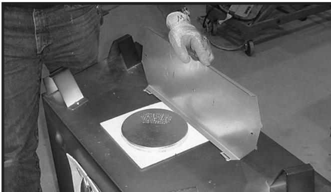
Figure 6.6 Faites tourner l'écran thermique supérieur en position verticale, comme indiqué ci-dessus. L'écran thermique doit demeurer en position verticale.
