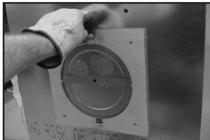
**Figure 6.12 (foyer générique illustré)** Pliez les languettes vers le centre du branchement au feu (90°) puis enlevez le joint d'isolation.
