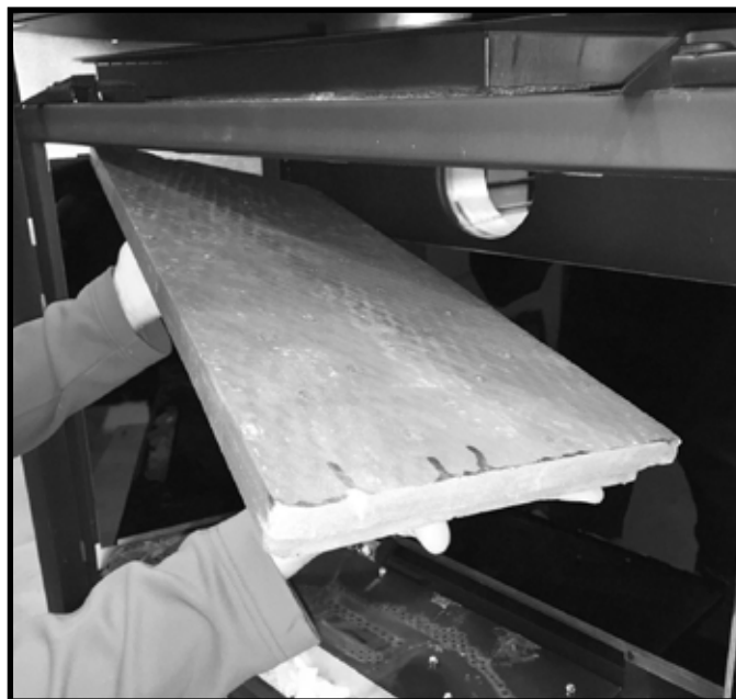
Figure 11.16 Installation du panneau réfractaire supérieur
