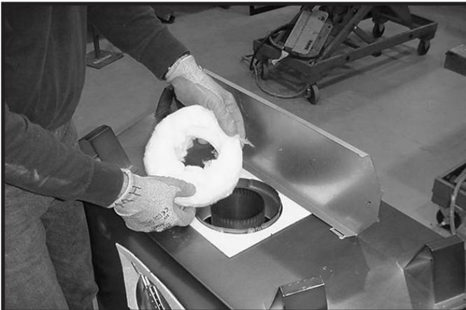
**Figure 6.10** Retirez l'isolation du conduit d'évacuation extérieur.
