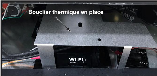
Figure 11.2 Bouclier thermique installé
