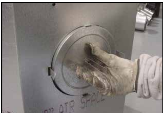
Figure 6.9 Repliez les parties centrales de la bande de retenue vers le centre, tel que montré. Enlevez le couvercle de fermeture.
