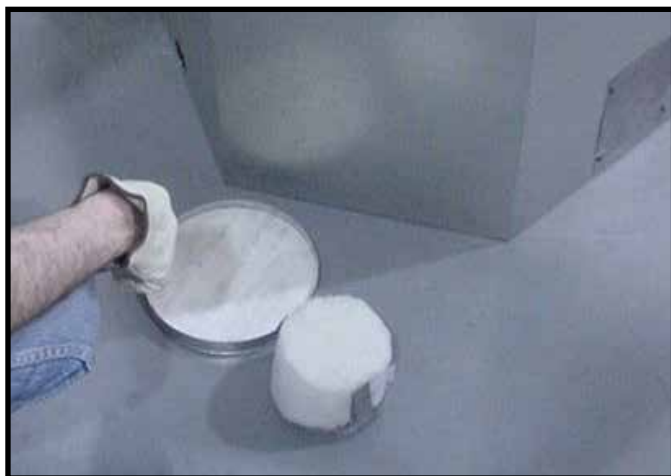
Figure 6.10 Jetez le couvercle du conduit, enlevez et jetez le panier d'isolant. Remarque : Une fois enlevé, le couvercle du conduit NE PEUT PAS être remis.
