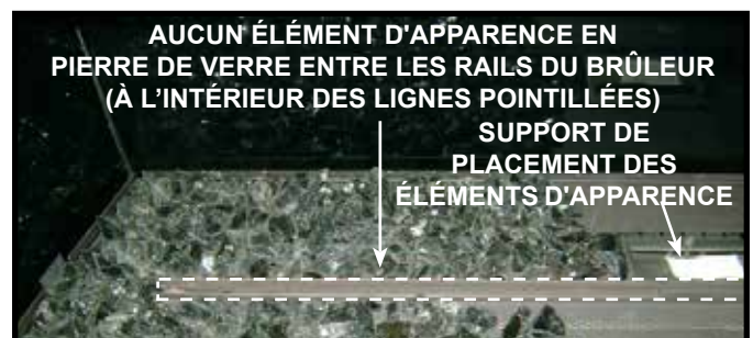
Figure 14.2. Installation de l'élément d'apparence en pierre de verre
