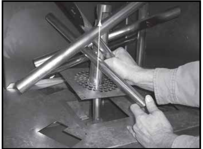
Figure 11.19 Retrait de l'ensemble de bûches en acier décoratif
