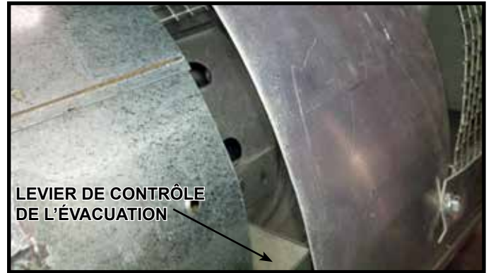
Figure 4.13 Ajustement du levier de contrôle PVK-80 – Ouvert
