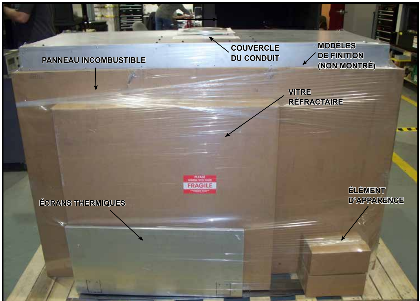
Figure 6.1. Emplacement de transport des composants
