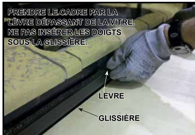
Figure 11.6. Installer la vitre
