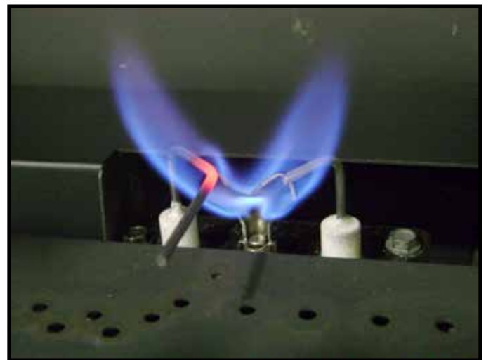
Figure 3.2 Modèles de flamme de la veilleuse IPI
