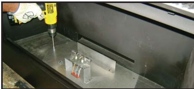
Εικόνα 16.5 Αφαίρεση βιδών έδρας βαλβίδας
