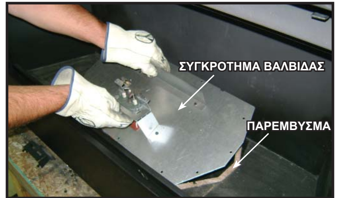
Εικόνα 16.6 Αφαίρεση έδρας βαλβίδας
