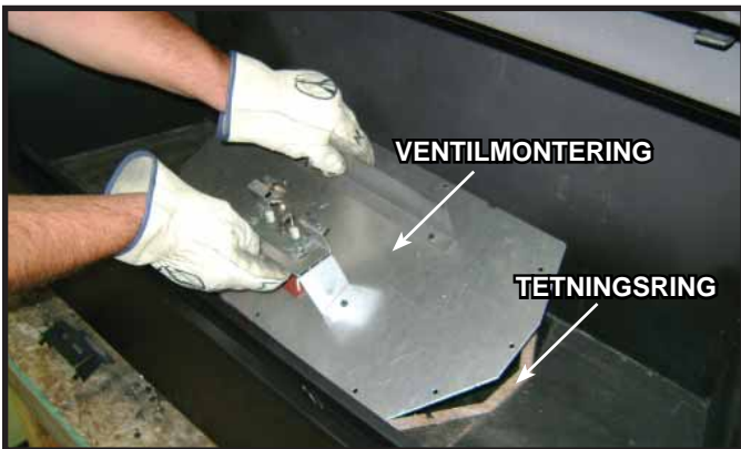
Fig. 16.6 Fjerning av ventilplate
