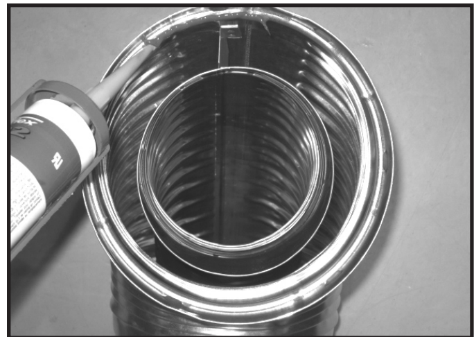
Abbildung 10.2 Dichtung aus temperaturbeständigem Silikon
