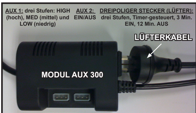
Abbildung 12.10 Anschließen des Lüfters an das Modul AUX300CE
