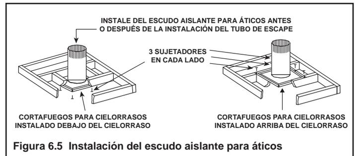
Figura 6.5 Instalación del escudo aislante para áticos
