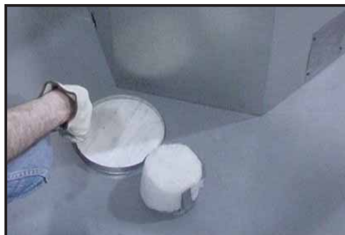
Fig. 9.11 Kast tetningslokket og fjern og kast isolasjonen. Merk: Når tetningslokket er fjernet, kan det IKKE festes på nytt.
