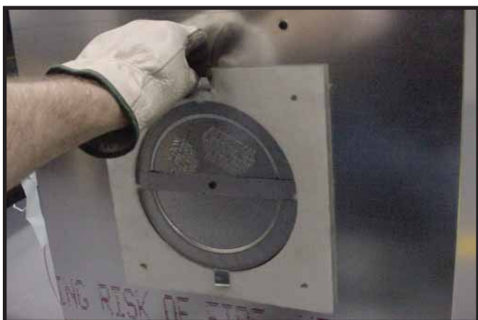
Fig. 9.8 Bøy maljene mot senter av tennpluggen (90°), og fjern isolasjonspakningen.
