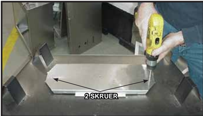
Fig. 9.1 Ved toppventilering, fjern de to skruene som holder varmeskjoldet på toppen. For ventilering bak, se avsnitt 9.B.
