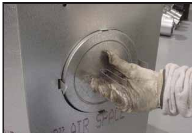
Fig. 9.10 Bøy midtdelene av festebåndet utover, og bruk dette for å fjerne tetningslokket.
