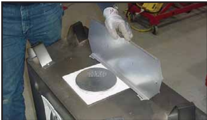
Fig. 9.2 Drei varmeskjoldet på toppen til vertikal posisjon som vist ovenfor. Varmeskjoldet må stå i vertikal posisjon.
