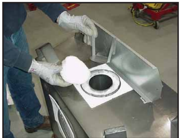
Fig. 9.5 Fjern isolasjonen og den hvite isolasjonen fra senter i avtrekksrøret.
