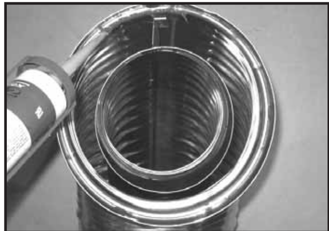
Obr. 10.1 Silikónové tesnenie odolné voči vysokým teplotám
