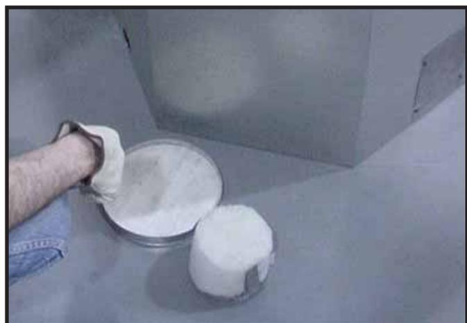
**Abbildung 9.11** Legen Sie die Dichtungskappe beiseite, entfernen Sie den Isolationskorb und legen Sie ihn beiseite. Hinweis: Eine einmal entfernte Dichtungskappe kann NICHT wieder angebracht werden.
