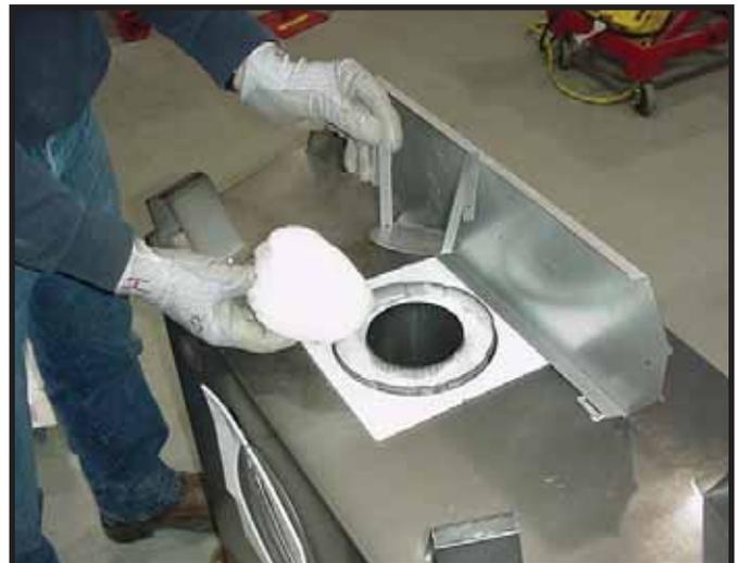
**Abbildung 9.5.** Entfernen Sie den Isolationskorb aus der Mitte des Abzugsrohrs.
