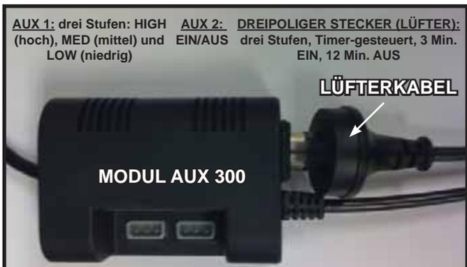
Abbildung 12.10 Anschließen des Lüfters an das Modul AUX300CE
