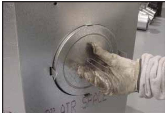
**Abbildung 9.10** Biegen Sie den Mittelteil des Haltestreifens nach außen, und verwenden Sie ihn, um die Dichtungskappe zu entfernen.
