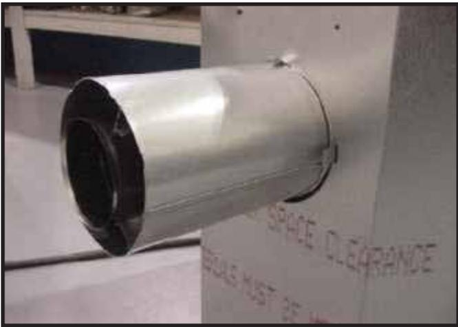
**Abbildung 9.13** Bringen Sie das erste Abzugssegment an (bis es einrastet). Schieben Sie die Isolationsdichtung auf dem Abzugssegment über die Laschen auf das Gerät zu.
