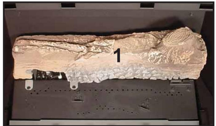
**SCHEIT NR.1 (SRV327-701):** Platzieren Sie Scheit 1 hinten im Gerät. Die linke Kante muss sich hinter der Lasche der Pilothalterung befinden. Die rechte Seite liegt hinter der Lasche auf der Halterung.
