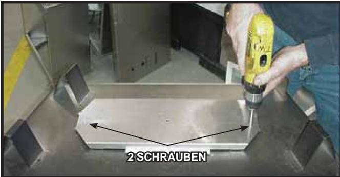
**Abbildung 9.1** Beim oberen Abzug entfernen Sie die beiden Schrauben, die den Hitzeschild in Position halten. Rückwärtiger Abzug, siehe Abschnitt 9.B.
