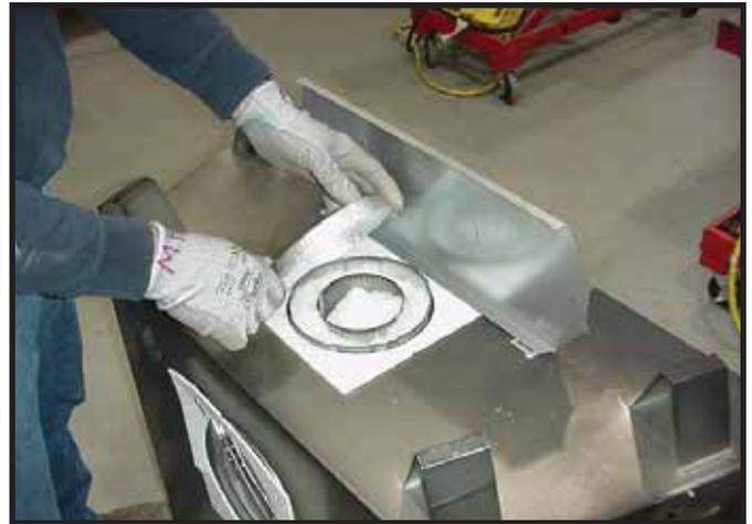
**Abbildung 9.4** Entfernen Sie die Dichtungskappe.
