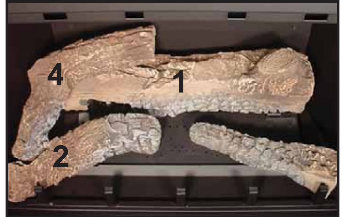
BRÆNDESTYKKE NR. 4 (SRV530-716): Placer venstre ende af brændestykke nr. 4 i rillen på brændestykke nr. 2 og højre ende af brændestykke nr. 1 som vist.
