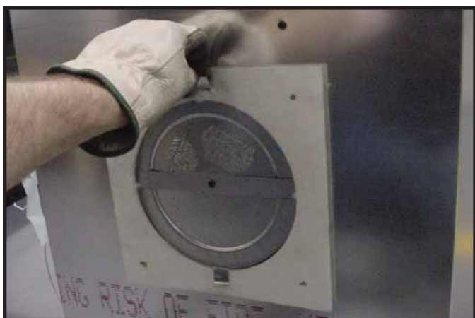
Figur 9.8 Fold taperne mod midten af varmeovens brandstuds (90°), og fjern isoleringsproppen.
