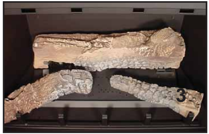
BRÆNDESTYKKE nr. 3 (SRV705-703): Lad brændestykke nr. 3 hvile mod risthjørnet forrest til højre, og placer stykkets rille over den højre brændertap.
