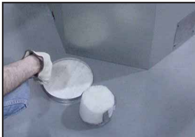
Figur 9.11 Smid forseglingsdækslet ud, og fjern og smid isoleringsproppen ud. Bemærk: Når forseglingsdækslet er fjernet, kan det IKKE påmonteres igen.
