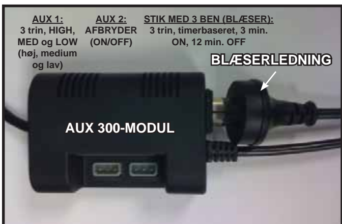
Figur 12.10 Slut blæseren til AUX300CE-modulet
