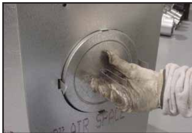
Figur 9.10 Fold den midterste del af båndet udad, så du kan fjerne forseglingsdækslet.
