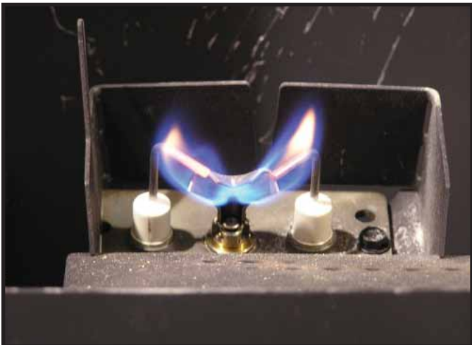
Figur 3.1 IPI fortændingsflammens mønster
