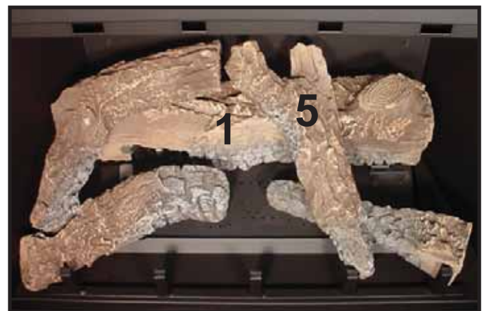
BRÆNDESTYKKE NR. 5 (SRV438-724): Placer toppen af brændestykke nr. 5 på brændestykke nr. 1 og brændestykke nr. 3, og placer bunden på højre side af den fjerde ristspids.
