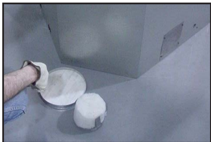
Figura 9.11 Deseche la tapa selladora y el retenedor de aislamiento. Nota: Una vez de que se haya retirado la tapa selladora, ésta no se puede volver a instalar.
