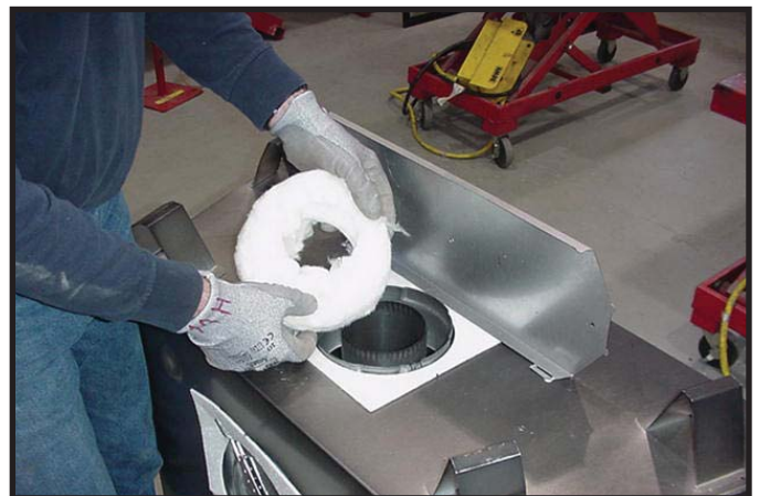
Figura 9.6 Retire el aislamiento del conducto exterior.
