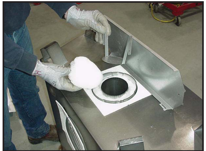
Figura 9.5 Retire el retenedor de aislamiento y el aislamiento que se encuentra dentro del conducto central.
