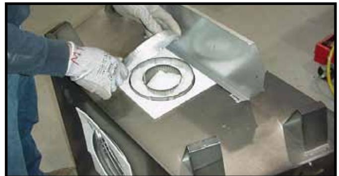
**Abbildung 19.** Entfernen Sie die Abzugskappe.
