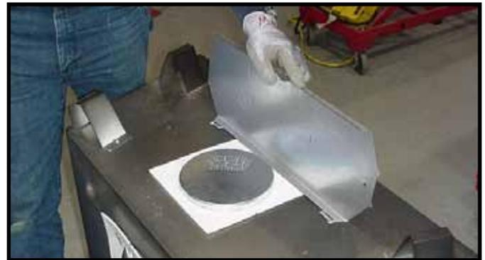
**Abbildung 17.** Drehen Sie den oberen Hitzeschild wie oben gezeigt in die vertikale Position. Der Hitzeschild muss in der vertikalen Position bleiben.
