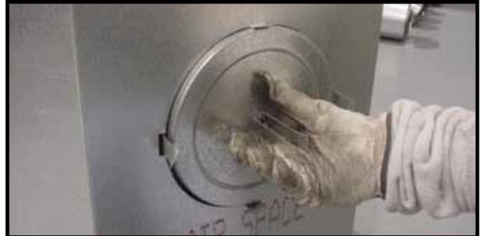
**Abbildung 25.** Biegen Sie den Mittelteil des Haltestreifens nach außen, und verwenden Sie ihn, um die Abzugskappe zu entfernen.
