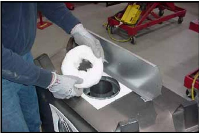
**Abbildung 21.** Entfernen Sie die Isolierung vom äußeren Gaszugrohr.
