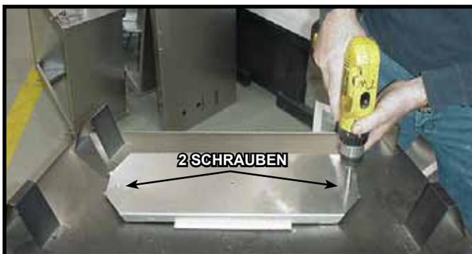
**Abbildung 16.** Für den oberen Abzug entfernen Sie die beiden Schrauben, die den Hitzeschild in Position halten. Hinweise zum rückseitigen Abzug finden Sie auf der nächsten Seite.
