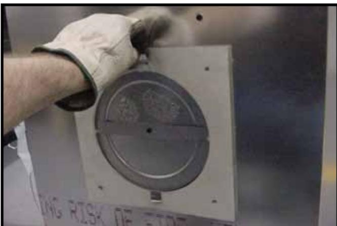
**Abbildung 23.** Entfernen Sie die Isolierung vom äußeren Gaszugrohr.
