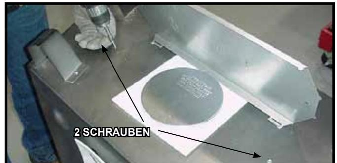
**Abbildung 18.** Schrauben Sie die beiden Schrauben wie gezeigt wieder fest.
