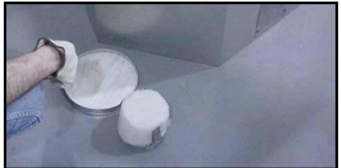
**Abbildung 26.** Legen Sie die Abzugskappe beiseite, entfernen Sie den Isolationskorb und legen Sie ihn beiseite. Hinweis: Nach der Entfernung der Abzugskappe, kann sie NICHT wieder angebracht werden.
