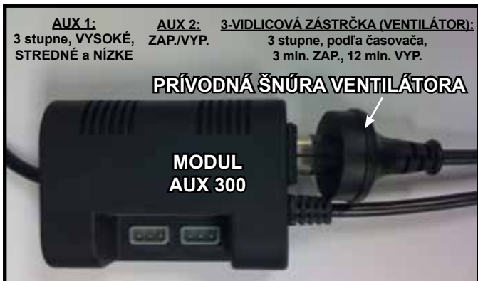
Obr. 12.10 Zapojenie ventilátora do modulu AUX300CE
