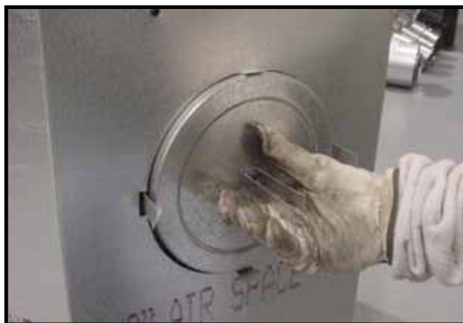
Obr. 9.10. Stredovú časť prídržného pásu ohnite smerom von a pomocou nej vyberte tesniaci kryt.
