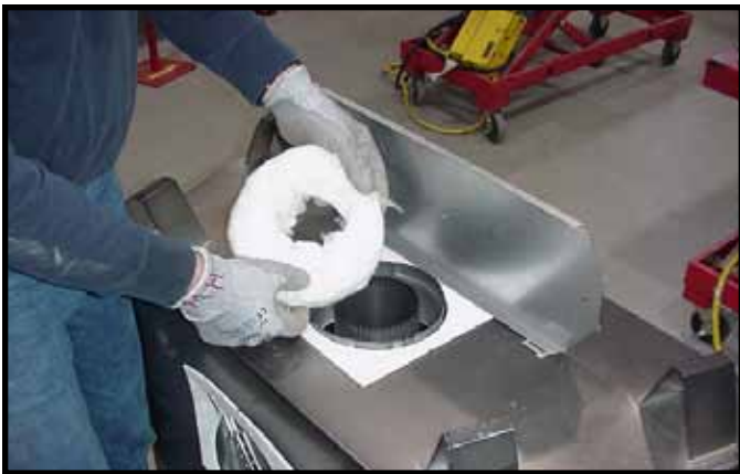
Figur 21. Fjern isoleringsmaterialet fra den ydre del af skorstensrøret.
