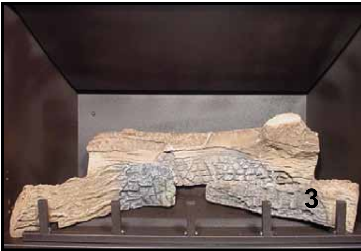
BRÆNDESTYKKE NR. 3 (SRV705-703): Lad brændestykke nr. 3 hvile mod risthjørnet forrest til højre, og placer stykkets rille over den højre brændertap.
