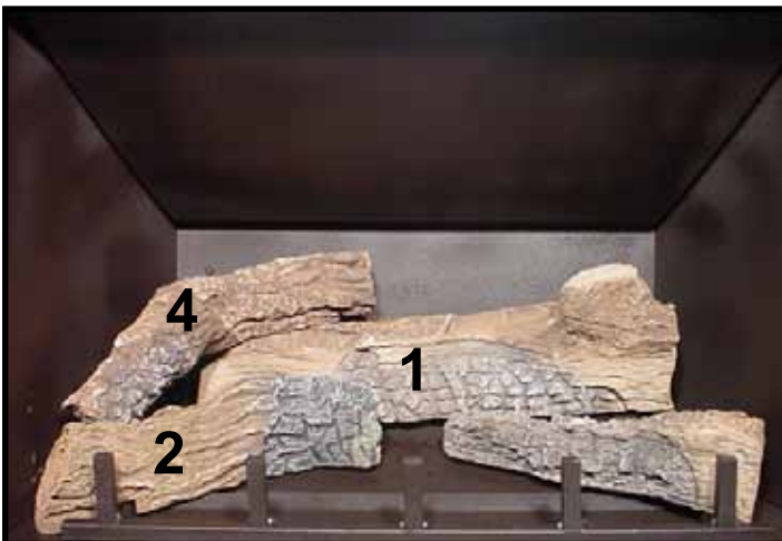
BRÆNDESTYKKE NR. 4 (SRV530-716): Placer venstre ende af brændestykke nr. 4 i rillen på brændestykke nr. 2 og højre ende af brændestykke nr. 1 som vist.
