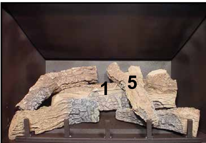
KUBBE NR. 5 (SRV438-724): Legg oversiden av kubbe nr. 5 på kubbe nr. 1 og plasser undersiden på høyre siden av risten til kubbe nr. 4.
