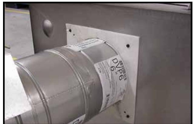
Figur 27. Fest den første delen av avtrekksrøret (den vil klikke på plass). Trekk isolasjonspakningen over avtrekksrøret, inntil kassen og over tappene. Bruk to mutterløse skruer til å feste pakningen til kassen.
