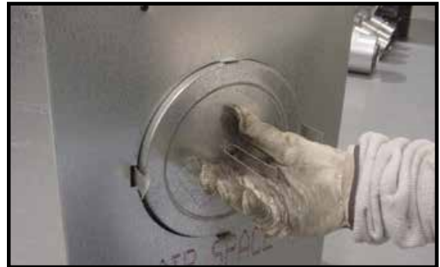
Figur 25. Bøy de midtre delene av båndet utover og bruk dem til å fjerne avtrekkshetten.
