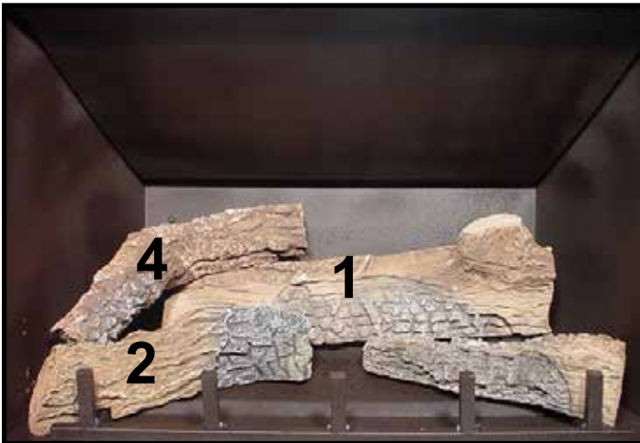
KUBBE NR. 4 (SRV530-716): Plasser venstre ende av kubbe nr. 4 i sporet på kubbe nr. 2 og høyre ende på kubbe nr. 1, som vist på figuren.
