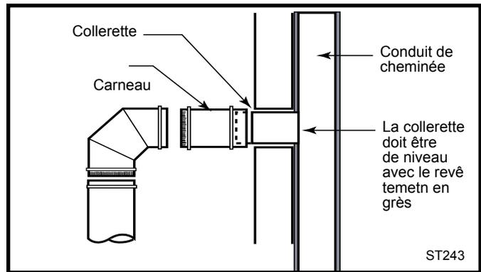
**Fig. 6** La collerette, en céramique ou en métal, doit être solidement collée en place.
