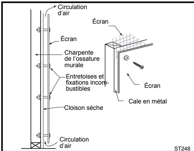
Fig. 12 Construction approuvée d'un écran mural.
