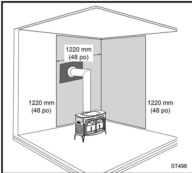
**Fig. 16** Installation parallèle avec passe-mur arrière, écrans à paroi double. Dégagements réduits pour les parois arrière et latérales. Les écrans thermiques muraux peuvent se rencontrer dans un coin, si désiré. Le passe-mur doit être conforme aux codes. Se reporter aux « Installations spéciales ».
