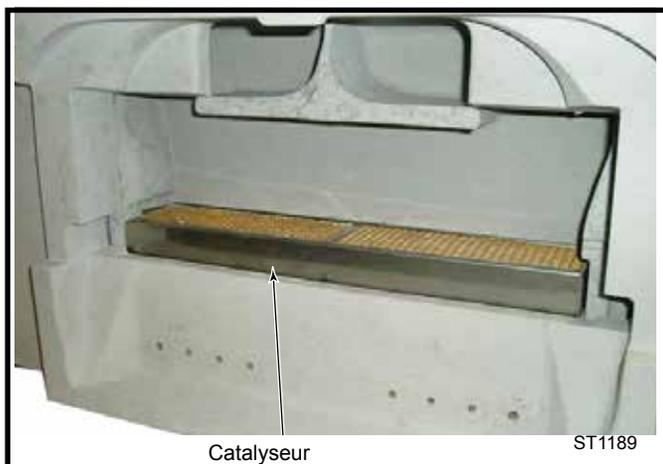
Fig. 30 Retirer le catalyseur.
