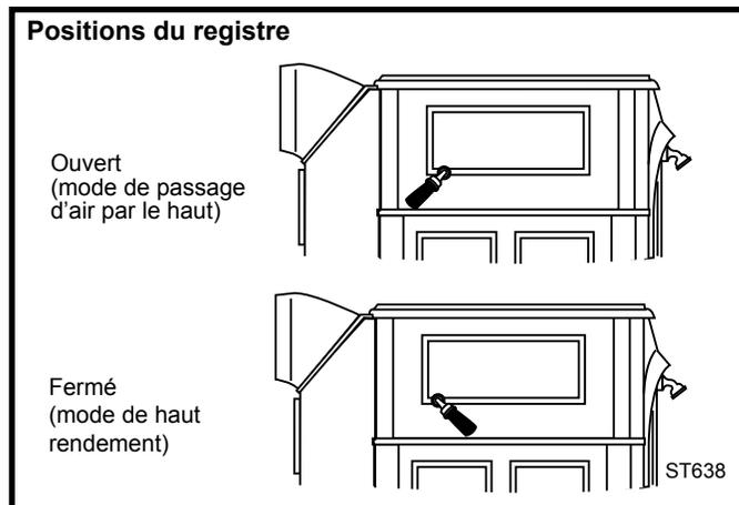
**Fig. 33** Positions de fonctionnement du registre du Encore.
