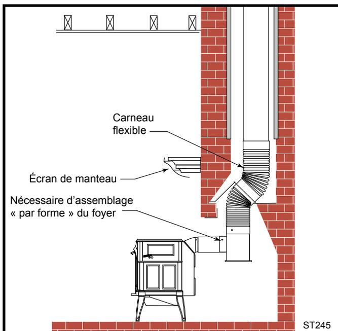
**Fig. 8** Installation par de foyer.
