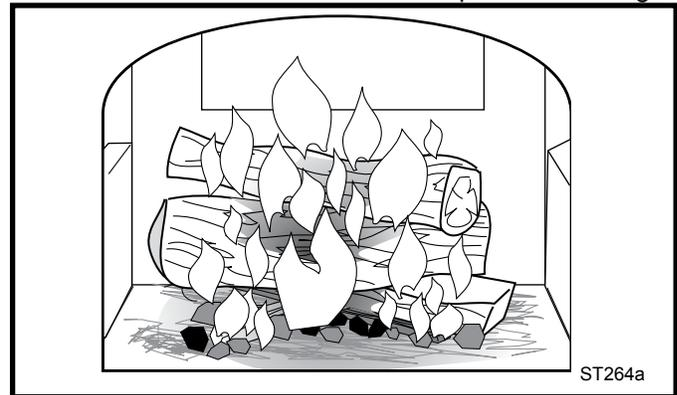
**Fig. 39** Ajoutez des bûches de pleine grandeur lorsque le lit de braise atteint au moins 76 mm (3 po) d'épaisseur.
