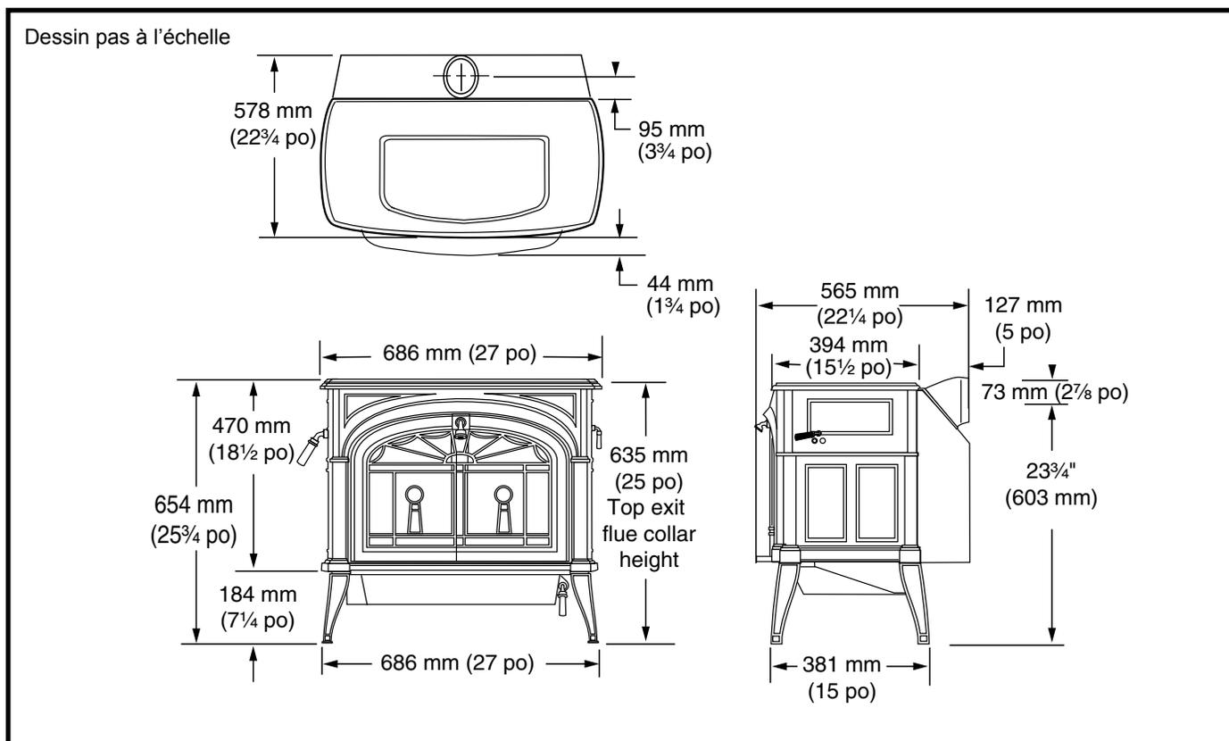
Fig. 1 Dimensions du modèle Encore.
