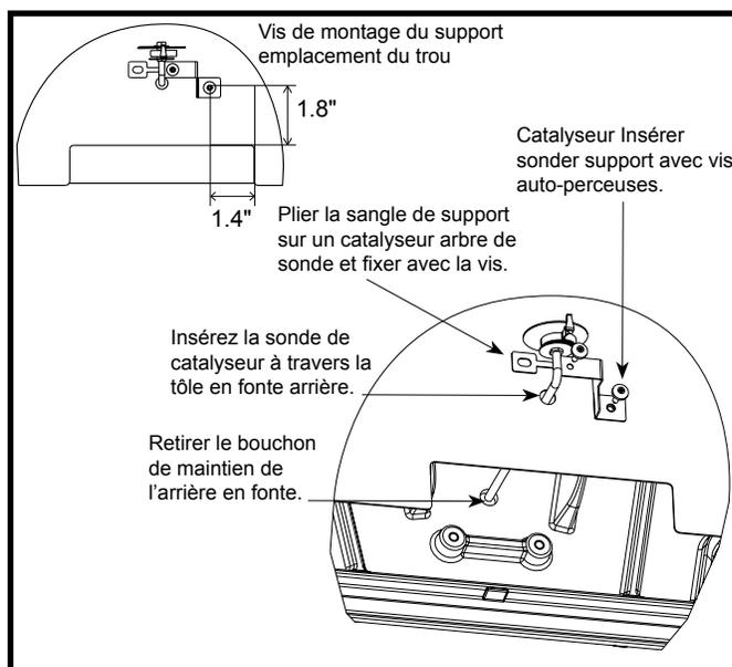
Fig. 24 Fixez la sonde de température
