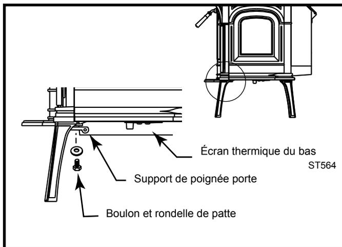
Fig. 21 Positions du porte-poignée et de l'écran thermique.
