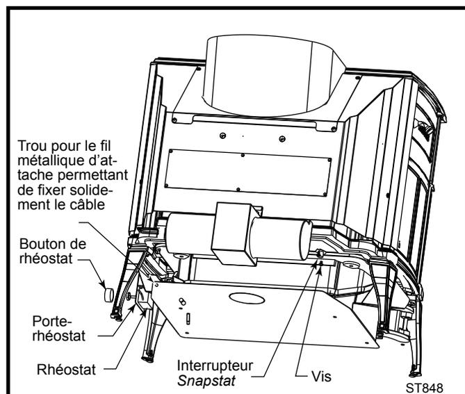
Fig. 27 Installation du ventilateur (nécessaire n° 2767).
