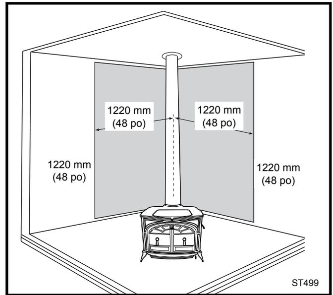
**Fig. 17** Installation en coin, carneau vertical, écrans à paroi double. Dégagements latéraux réduits. Les écrans muraux DOIVENT se rencontrer dans le coin.
