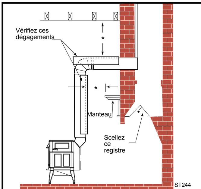
**Fig. 7** Dans cette installation, le carneau est fixé à la cheminée, au-dessus de l'ouverture du foyer.
