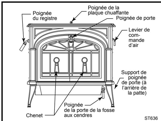
**Fig. 31** Les commandes du Encore sont placées à portée de main et faciles à utiliser.
