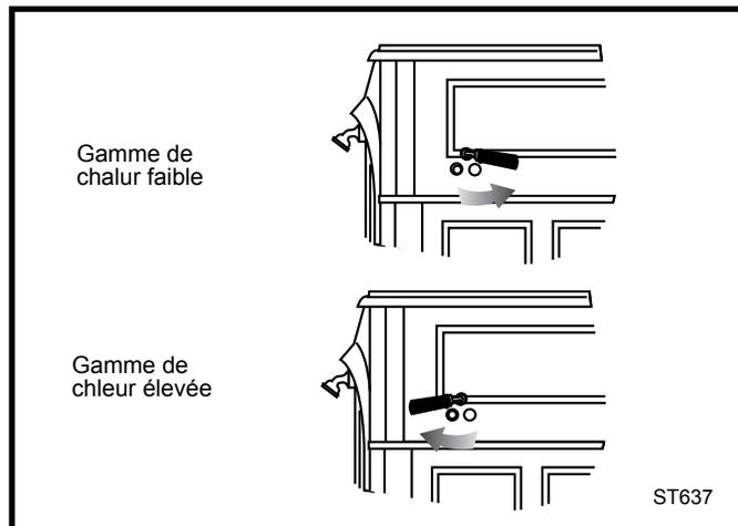
**Fig. 32** La poignée peut aussi être placée n'importe où entre les deux positions extrêmes pour obtenir des chaleurs différentes.
