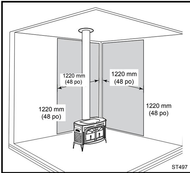
**Fig. 15** Installation parallèle, carneau vertical, écrans à paroi double. Dégagements réduits pour les parois arrière et latérales. Les écrans thermiques muraux peuvent se rencontrer dans un coin, si désiré. Les écrans du carneau sont centrés derrière celui-ci.
