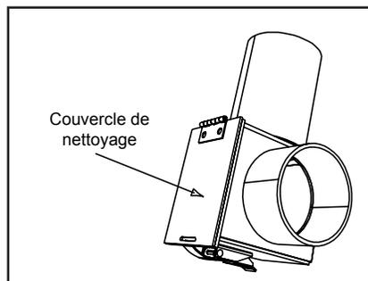
Figure 20.4 – Adaptateur supérieur de ventilation arrière – 90°
