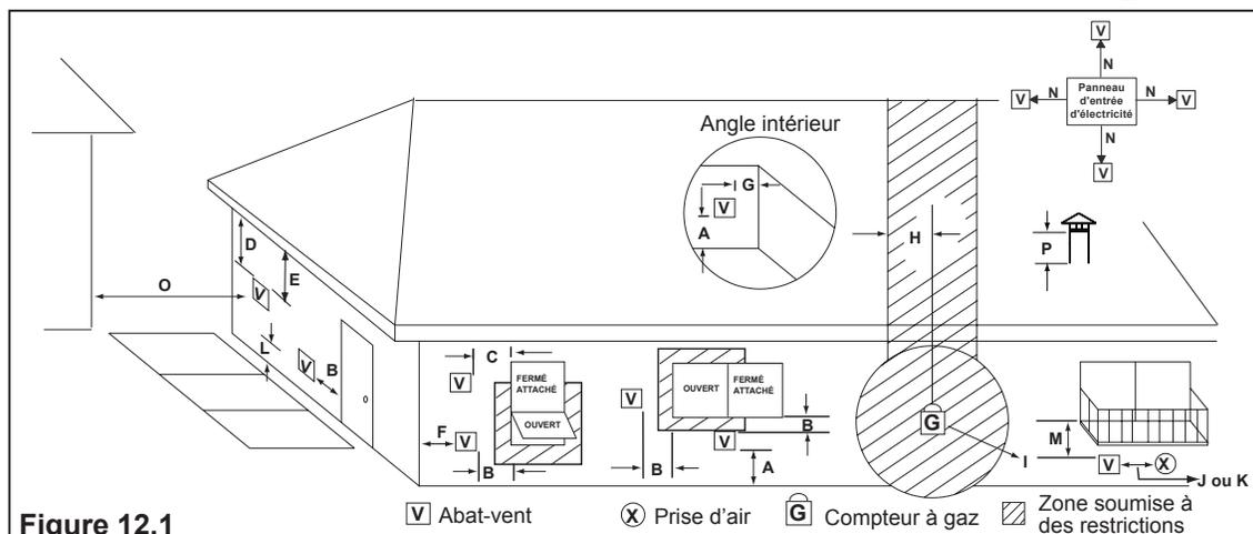
Tous les dégagements minimum correspondent à une installation avec prise d'air extérieur, sauf indication contraire figurant au tableau ci-dessous.
