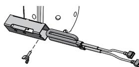
Un allumeur de 300 watts est installé dans un nouveau mont. Vernon AE et ne doivent être utilisés qu'avec du combustible à granulés. L'allumeur 380 Watt est nécessaire pour la combustion de carburants multi-grains et est inclus dans le pack composant. Les combustibles multiples incluent, le maïs, les graines de tournesol et le blé.
