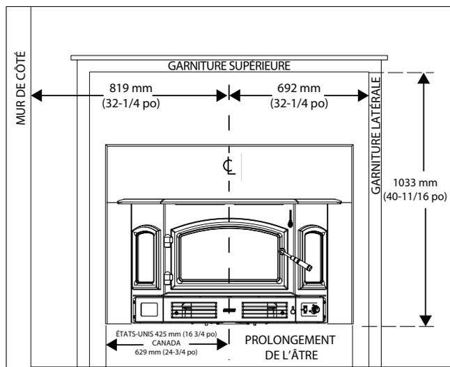
**\*REMARQUE:** Si la mesure de la garniture est supérieure à 3/4 po (19 mm) en profondeur, utilisez le manteau ou les dégagements latéraux sur les combustibles.
