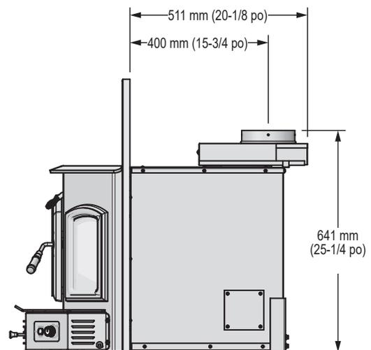
Figure 8.5 - Vue latérale avec Surround en acier et adaptateur de décalage optionnel (OFFSET-ADAPT)
