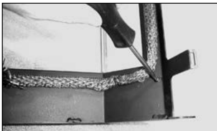
Figure 8.7 - Désinstallez la couronne existante en enlevant les quatre vis à l'arrière de la porte. Conserver les vis.
