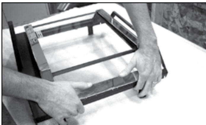
Figure 8.9 - Soigneusement aligner le côté gauche de la couronne en place, et l'envelopper à travers la face de la porte, en l'agrippant finalement en place sur le côté droit. Reinsérer et serrer les vis précédemment enlevées.
