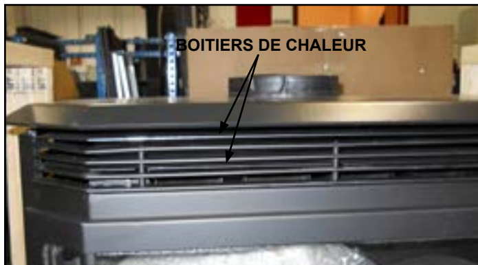
Figure 8.1 - Avant de retirer la porte, notez l'emplacement des protections thermiques intérieures entre les ailettes de la grille de la porte. Les écrans thermiques devront rester à ces emplacements lors du remontage de la porte.
