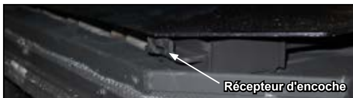
Figure 8.6 - L'encoche sur l'ensemble avant est accrochée sur le dispositif de retenue en haut du poêle. Il sera nécessaire d'appliquer une petite quantité de force sur le haut de l'avant lors du retrait de l'avant de l'appareil. Lors du pivotement de l'avant en s'éloignant de l'appareil, poussez vers le haut et vers l'intérieur pour libérer les encoches de crochet des supports d'encoche.
