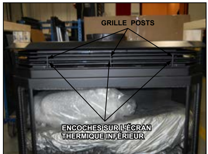
Figure 8.4 - Lors du remontage de la porte, veillez à aligner le bouclier inférieur dans la grille centrale, alignez le poteau de grille avec les encoches dans le bouclier thermique inférieur. Une fois que les boucliers sont alignés (le poteau doit être aligné avec l'avant des boucliers) pousser vers le haut sur les boucliers en utilisant la porte et pousser dedans pour laisser la porte se reposer sur les verrous. Figure 8.4.
