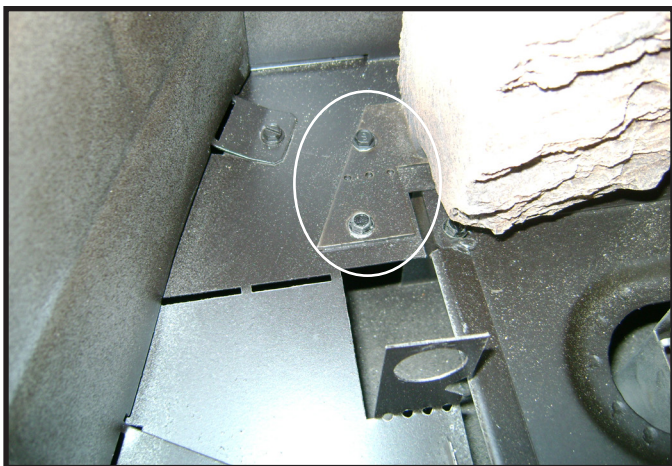
Figure 4.8 Retirez les deux vis des languettes de la bûche
