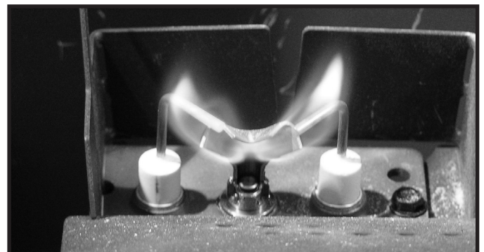
Figure 4.2. Comportement de la flamme de la veilleuse IPI
