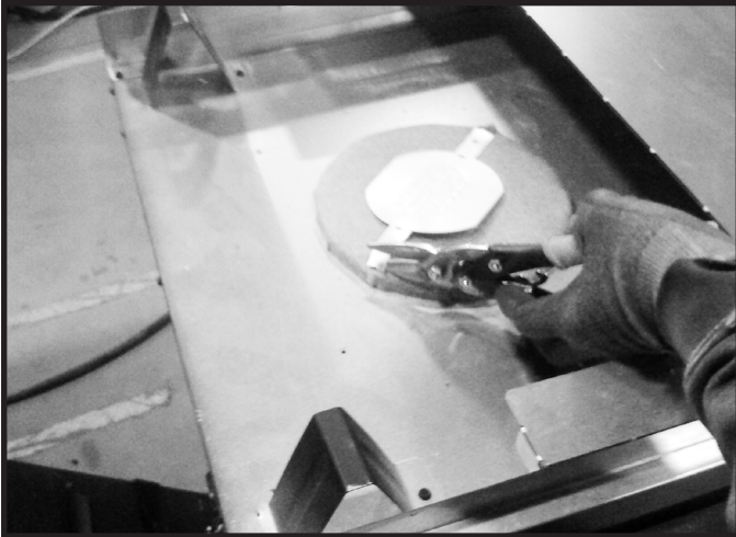
Figure 6.1 Coupez la bande métallique de retenue et pliez les deux parties coupées vers l'extérieur.
