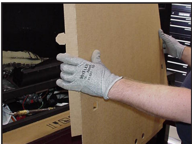
Figure 11.4 Plier les côtés droit et gauche de l'anti-projection
