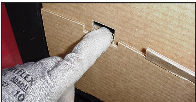
Figure 11.10 Fixation des languettes à l'intérieur de l'avant de l'anti-projection
