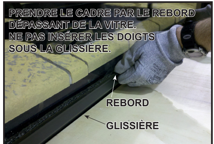
Figure 11.6. Installer la vitre
