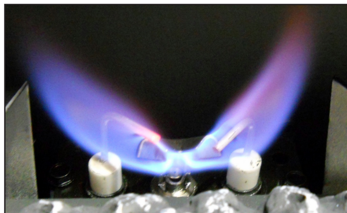
Figure 4.3 Forme de flamme de la veilleuse IPI
