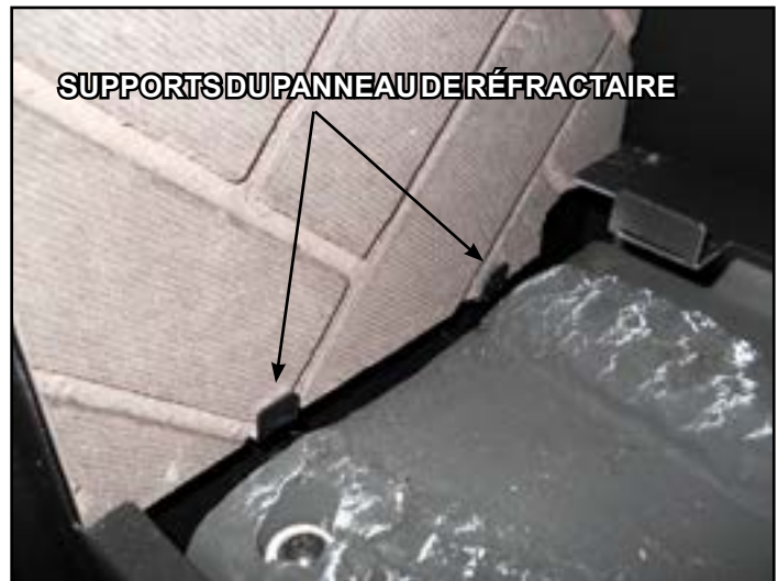
Figure 10.6 Supports inférieurs du réfractaire
