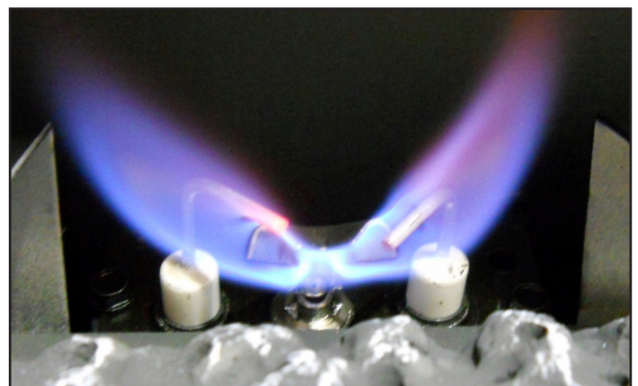
Figure 4.3 Forme de flamme de la veilleuse IPI
